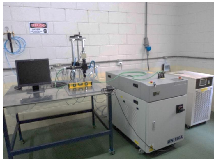
FIGURA 5 - Sistema laser Nd: YAG pulsado, modelo UW-150A United Winners
